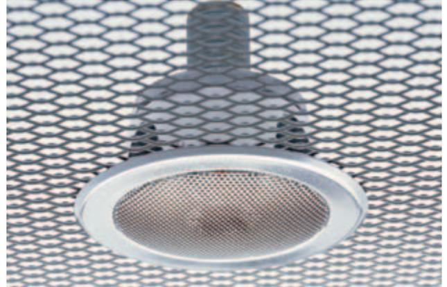
Die verdeckten Undercover-Sprinkler sind mit Feingitterblende und dem zugehörigen Abwurfsystem CoverDrop ausgestattet.
