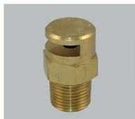
**TraFoProtect Düsen vom Typ C** werden in TraFoProtect Anlagen optional im flachen Bodenbereich unterhalb des Transformators installiert, um gezielt Lachenbrände in der Bodenwanne zu bekämpfen. Charakteristisch für diesen Düsentyp ist das fächerförmige Sprühbild mit einem Sprühwinkel von 180°.
