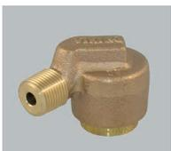
**TraFoProtect Düsen vom Typ A** sind die am häufigsten in TraFoProtect Anlagen vorgesehenen Löschdüsen. Sie erzeugen ein homogenes Vollkegelsprühbild. Mittels verschiedener Düseneinsätze können Sprühwinkel von 90° oder 120° realisiert sowie der Löschwasserdurchsatz je Düse variiert werden, um eine optimale Anpassung an die Geometrie des zu schützenden Transformators zu erreichen.
