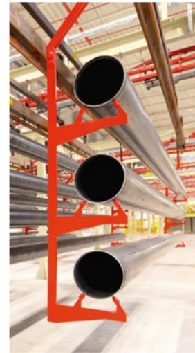
In einem hoch integrierten und automatisierten Prozess entstehen bei MV Pipe Technologies aus einfachen Stahlrohren maßgeschneiderte Verteiler- und Strangrohre – entsprechend der individuellen Anlagenplanung des Minimax Konstrukteurs sowie mit der gewünschten Oberflächenbehandlung und Farbe. Mit den vorgefertigten Rohren können auf der Baustelle schnell und effizient komplette Rohrnetze für Wasser-Löschanlagen installiert werden.
