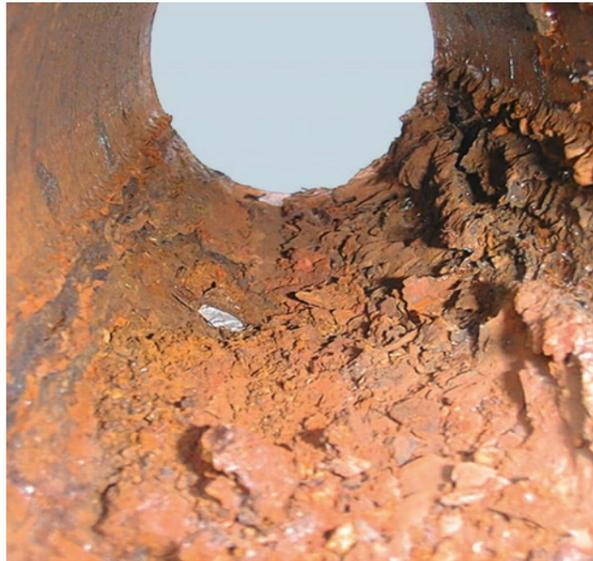
Korrosion im Inneren eines unbehandelten Rohrs
