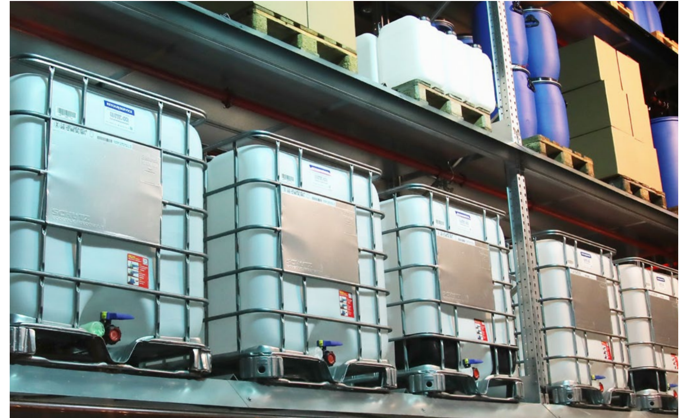
Entrepôts de matière dangereuses contenant des liquides inflammables
