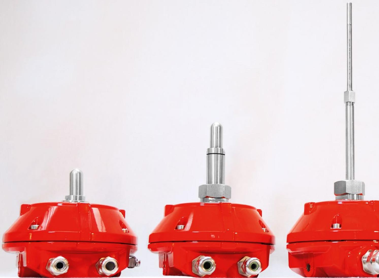
Der **WMX5000** ist zur Detektion von offenen Bränden mit schneller Wärmeentwicklung konzipiert, die beispielsweise bei leicht brennbaren Kunststoffen oder entzündlichen Flüssigkeiten und Gasen auftreten können. Die Brandkenngroße Wärme kann zur frühzeitigen Branderkennung neben der Maximaltemperaturmessung auch bei einem schnellen Temperaturanstieg differenziell ausgewertet werden.
