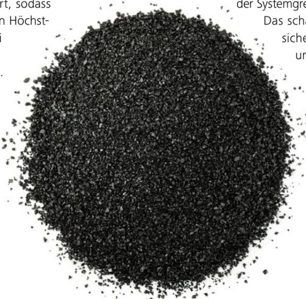
Abbildung 5: Kohlenstoffgranulat ist der elementare Baustein zur Trennung von Stickstoff- und Sauerstoffmolekülen in der PSA- und VPSA-Technologie.
