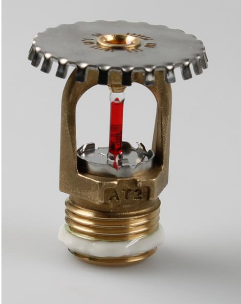
Bei der Verwendung des Dichtmittels ist die entsprechende Gebrauchsanweisung zu beachten. Mindestens auf dem zweiten und dritten Gewingdegang des Sprinklergewindes eine umlaufende Raupe Dichtmittel auftragen. Nur so viel Dichtmittel auftragen, wie unbedingt notwendig. Überschüssiges Dichtmittel ist zu vermeiden!
