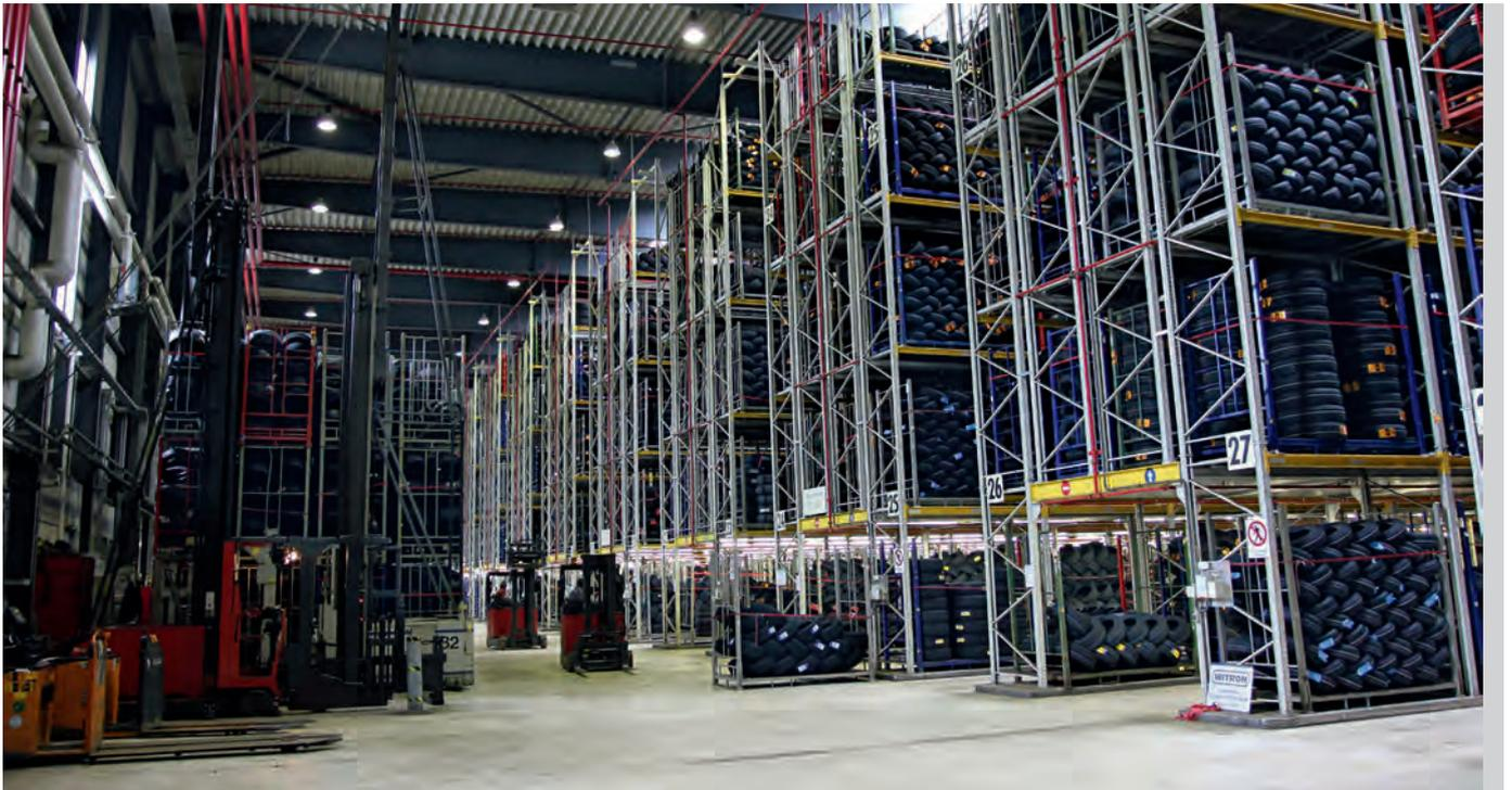
Reifen werden in der Regel in Blocklagern bevorratet. Zum Teil werden sie aber auch in speziell für die Reifenlagerung konstruierten Transportpaletten eingelagert.
